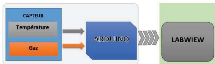
Figure1 : Synoptique du Système collecte d'odeur
